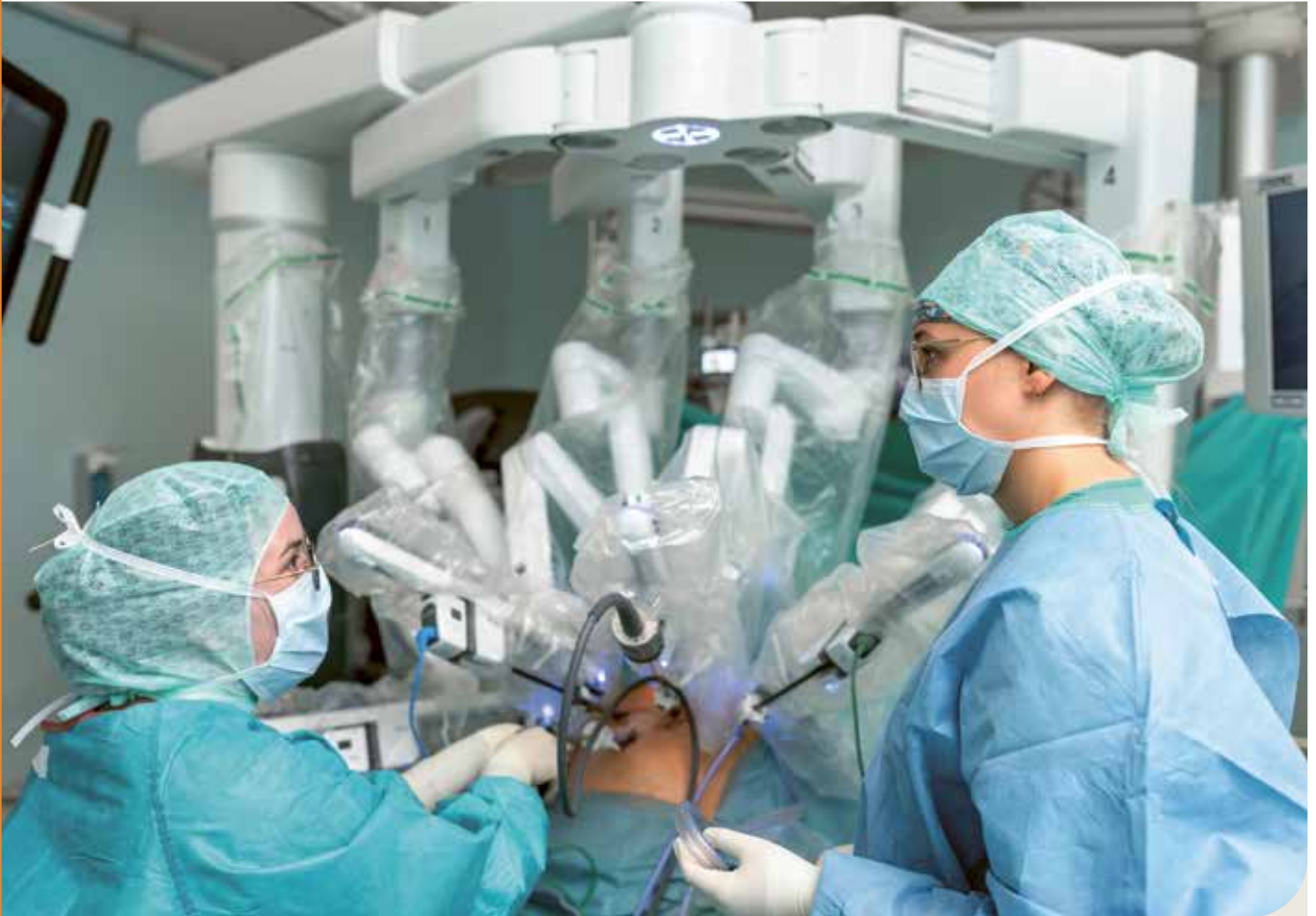
Die Roboterarme des Da-Vinci-Systems (Mitte) haben größere und präzisere Bewegungsmöglichkeiten als ein menschlicher Chirurg. Neben dem operierenden Chirurgen begleiten und unterstützen weitere Ärztinnen und Ärzte sowie OP-Pflegekräfte den anspruchsvollen Eingriff.
