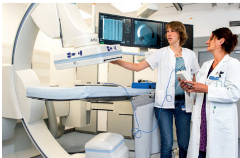
Auf Herz und Nieren: Josefin Hartmann (l.) und Lenka Frydrych-Singer (r.) messen, ob Röntgen- und Angiografiegeräte auch technisch einwandfrei arbeiten.
